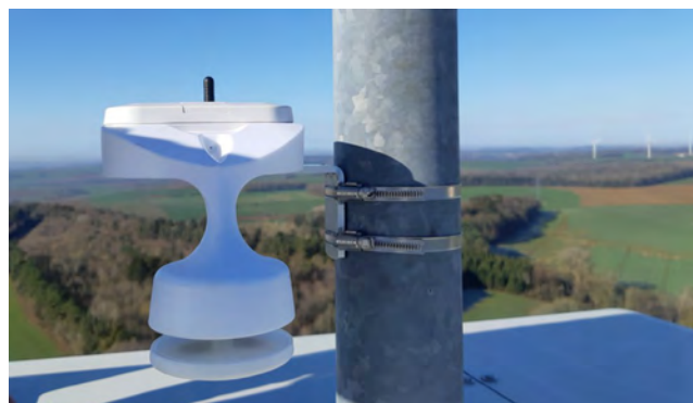
Windfit box équipant une éolienne de 3 MW
